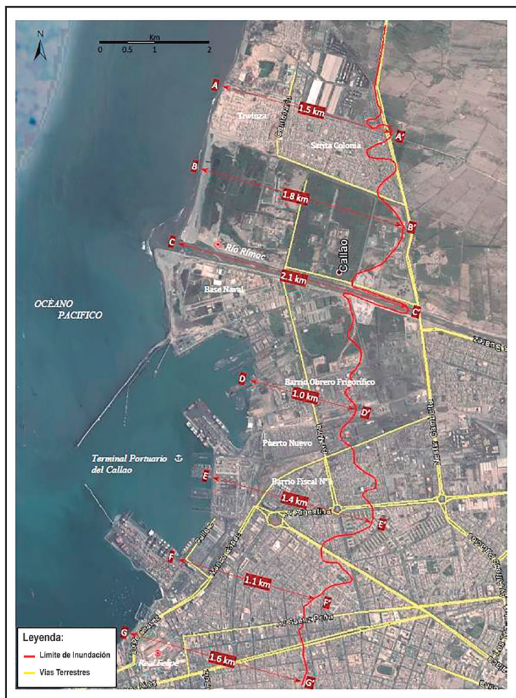
Figura 13: Escenario de inundación por tsunami producido por un sismo de magnitud 8.5 Mw en la zona portuaria del Callao y el río Rímac (Martínez y Tavera, 2014)
